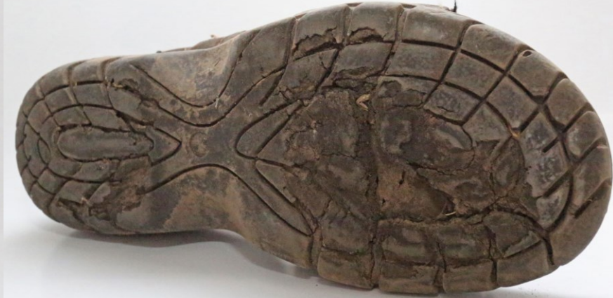
← ↑ Stark abgelöste und nicht mehr vollständige Sohle
