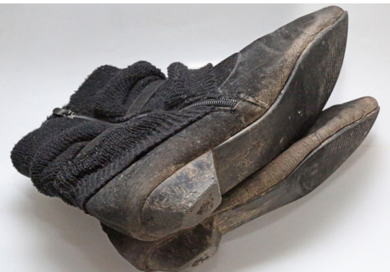
← Defekter Reißverschluss und durchgelaufene Absätze
