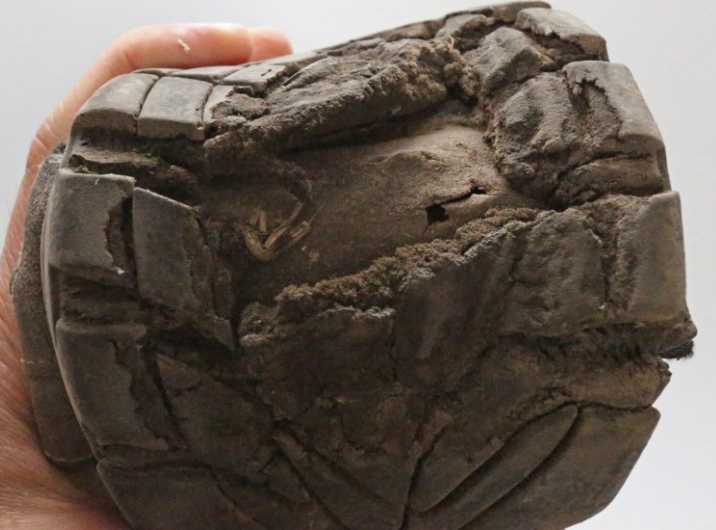
← ↑ Stark abgelöste und nicht mehr vollständige Sohle
